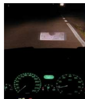
Εικονική οθόνη συστήματος βελτίωσης ορατότητας στο εμπρόσθιο τζάμι του οχήματος, όπως περίπου γίνεται και στα αεροσκάφη ("head up display").
