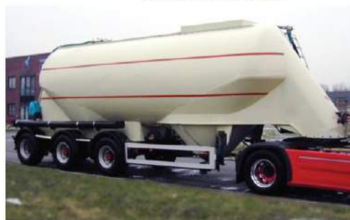
Βυτία-από για στερεές ύλες σε μορφή σκόνης ή κόκκων.
