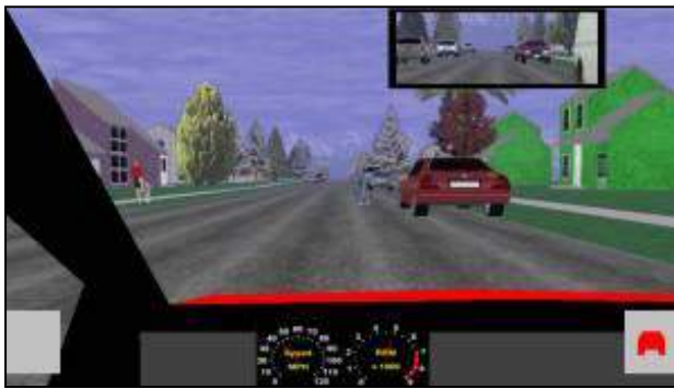
Εικόνα 2.20: Η εμπρόσθια κολόνα παρουσιάζεται στο οπτικό πεδίο του χρήστη αυτού του προσομοιωτή.
