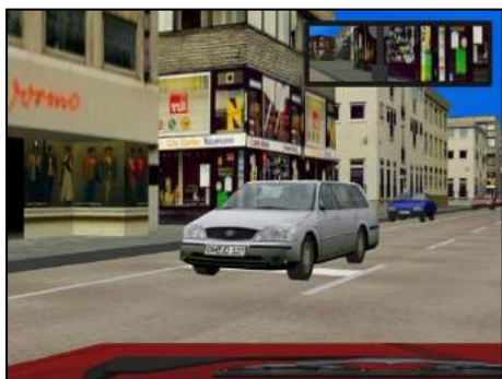
Εικόνα 2.17: Εικόνα προσομοιωτή με καλή ανάλυση. Φαίνεται καθαρά το επερχόμενο όχημα αλλά και το κυκλοφοριακό περιβάλλον. Φαίνεται επίσης η προσομοίωση του κεντρικού καθρέπτη.
