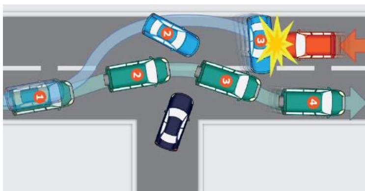
Εικόνα 7.7: Αποφυγή εμποδίου με απότομη πέδηση και προσπάθεια ελιγμού με και χωρίς ESP.
