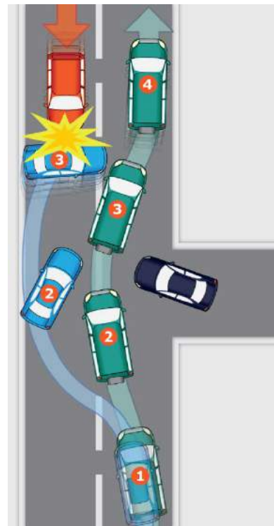
Εικόνα 30: Αποφυγή εμποδίου με απότομη πέδηση και προσπάθεια ελιγμού με και χωρίς ESP.
