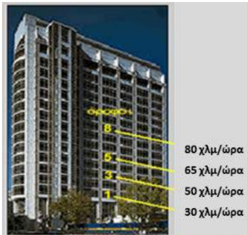
Εικόνα 5: Αντιστοίχιση των επιπτώσεων αυτοκινητιστικού ατυχήματος, αναλόγως της ταχύτητας κίνησης, με τα αποτελέσματα πτώσης από ορόφους κτιρίου.
