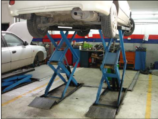
Εικόνα 33: Τυπική εικόνα ράμπας συνεργείου, με τη βοήθεια της οποίας γίνεται η ανύψωση του οχήματος για την πραγματοποίηση διάφορων επισκευών ή/και της τακτικής συντήρησης.
