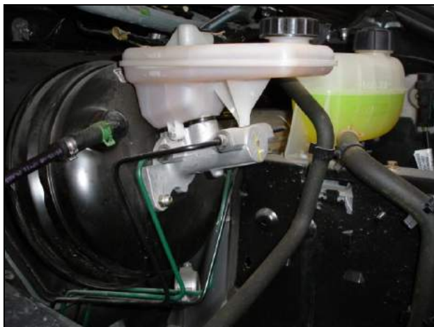
Εικόνα 5: Αριστερά διακρίνεται η δεξαμενή με τα υγρά φρένων (ροζ χρώματος), καθώς και τα σωληνάκια των φρένων, ενώ δεξιά η βοηθητική δεξαμενή με το αντιψυκτικό υγρό για το ψυγείο (κιτρινοπράσινου χρώματος).
