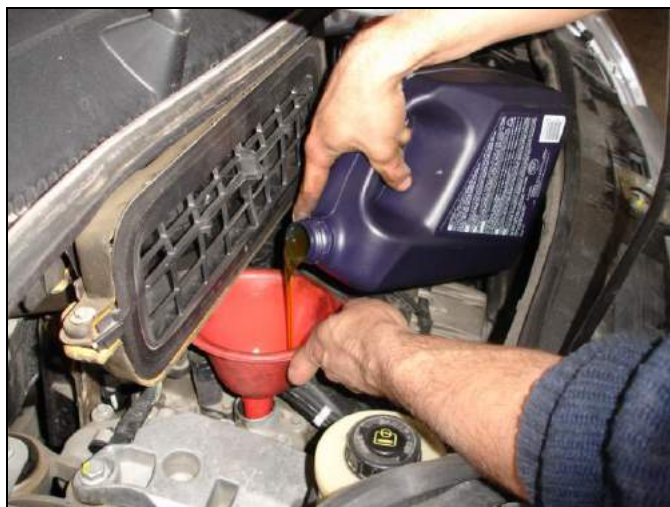
Εικόνα 4: Διαδικασία αλλαγής λαδιών στον κινητήρα.
