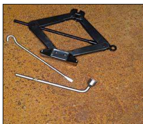
Εικόνα 25: Τα βασικά εργαλεία για αλλαγή τροχού. Αριστερά ο σταυρός και δεξιά το σύστημα ανύψωσης του αυτοκινήτου («γρύλλος»).
