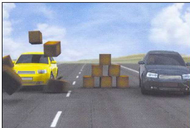
Εικόνα 68: Το κίτρινο όχημα φρενάρει χωρίς ABS, όμως η πορεία του είναι ευθεία παρόλο που ο οδηγός έχει στρίψει το τιμόνι δεξιά για να αποφύγει το εμπόδιο. Το μαύρο διαθέτει ABS, φρενάρει στο μέγιστο δυνατό βαθμό, αλλά ταυτόχρονα είναι ικανό να πραγματοποιήσει ελιγμούς (αφού οι τροχοί δε μπλοκάρουν) και τελικά αποφεύγει το εμπόδιο (Πηγή: Electronic Brake Control Systems help to avoid accidents, BOSCH).
