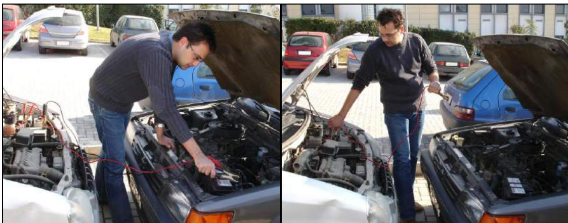
Εικόνα 23: Αποσύνδεση των καλωδίων. Ακολουθούμε την ακριβώς αντίστροφη διαδικασία από ότι στη σύνδεση. Πρώτα αφαιρούμε το μαύρο καλώδιο (αριστερή εικόνα) και έπειτα το κόκκινο (δεξιά εικόνα).
