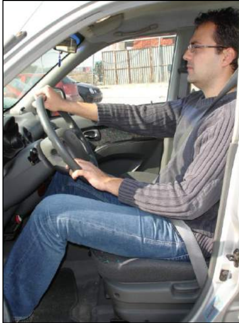
Εικόνα 20: Έλεγχος της απόστασης με το ένα χέρι, το οποίο πρέπει να προσεγγίζει τη θέση 12 του τιμονιού (επάνω μέρος) με σχετική άνεση και απλά να είναι ελαφρά τεντωμένο.
