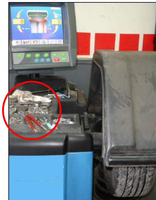
Εικόνα 34: Το μηχάνημα που πραγματοποιεί τη ζυγοστάθμιση. Διακρίνονται τα βαρίδια (σε κόκκινο κύκλο), ενώ στην οθόνη οι ενδείξεις δείχνουν το βάρος σε γραμμάρια που πρέπει να τοποθετηθεί σε κάθε πλευρά του τροχού. Εδώ το ελαστικό είναι ζυγοσταθμισμένο, σύμφωνα με τις μηδενικές ενδείξεις.
