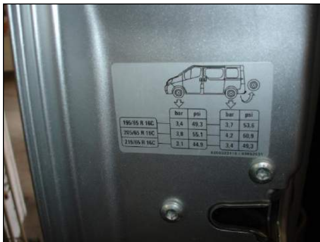
Εικόνα 16: Η ενδεικτική πινακίδα στην πόρτα του οδηγού για την απαιτούμενη πίεση των ελαστικών σε κάθε άξονα (εμπρός και πίσω) και για κάθε διάσταση ελαστικού.
