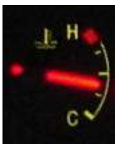
Εικόνα 31: Η κανονική ένδειξη της θερμοκρασίας βρίσκεται συνήθως περίπου πριν τη μέση.
