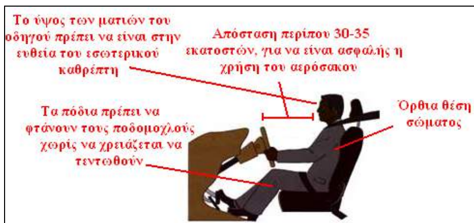
Εικόνα 72. Η σωστή θέση οδήγησης, επιτρέπει αφενός την εξασφάλιση πλήρους ορατότητας από τους καθρέπτες αλλά και την ασφαλή χρήση του αερόσακου.
