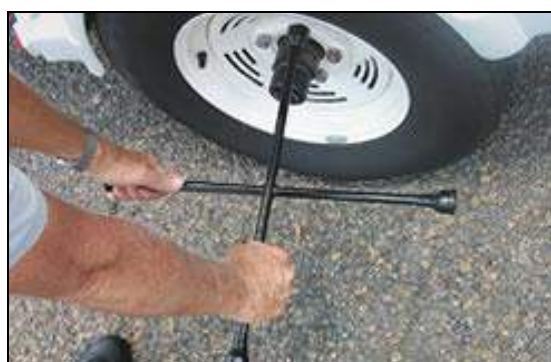
Εικόνα 26: Η σωστή χρήση του «σταυρού» για το ξεβίδωμα των μπουλονιών του τροχού.
