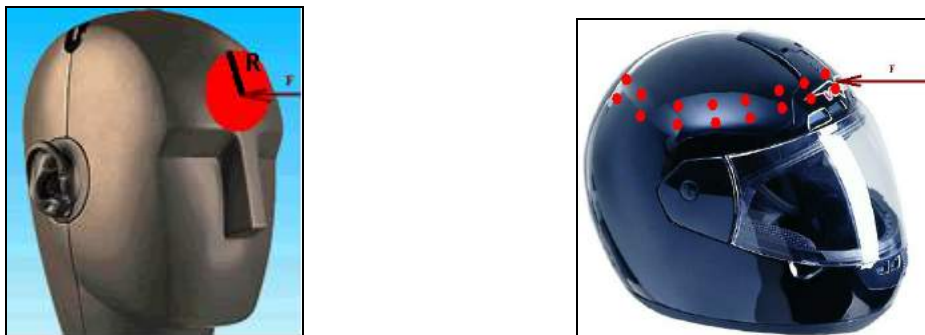
Εικόνα 57: Ο αναβάτης χωρίς κράνος δέχεται τη δύναμη της πρόσκρουσης σε μικρή επιφάνεια του κεφαλιού. Το κράνος ελαχιστοποιεί το αποτέλεσμα της δύναμης αυξάνοντας την επιφάνεια που δέχεται τη δύναμη και, επιπρόσθετα, με την εσωτερική επένδυση που έχει αμβλύνει το αποτέλεσμα.
