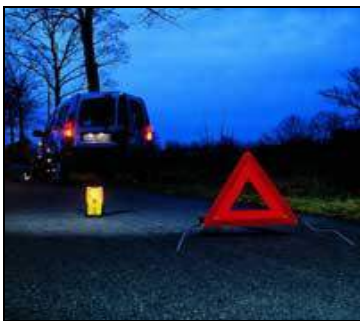
Εικόνα 29: Φωτεινό τρίγωνο και έντονο κίτρινο «τζάκετ» για προειδοποίηση επερχόμενων οχημάτων σε περίπτωση βλάβης.
