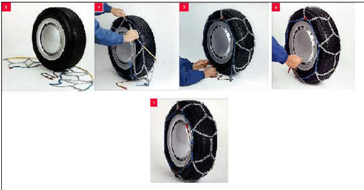
Εικόνα 67: Ενδεικτικά βήματα τοποθέτησης αντιολισθητικών αλυσίδων χιονιού.
