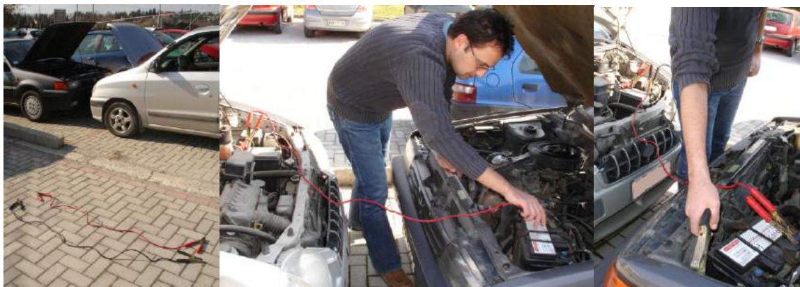
Εικόνα 22: Τοποθέτηση των καλωδίων για την αντιμετώπιση βλάβης της μπαταρίας. Τα οχήματα αντικριστά και τα καλώδια έτοιμα προς χρήση (αριστερά). Πρώτα συνδέουμε με το κόκκινο καλώδιο το θετικό πόλο του ανοιχτόχρωμου οχήματος που θα δώσει ρεύμα και μετά του σκουρόχρωμου που θα δεχτεί (μεσαία εικόνα). Στη συνέχεια με το μαύρο καλώδιο συνδέουμε πρώτα τον πόλο αυτού που θα δώσει και ένα μεταλλικό τμήμα του αμαξώματος αυτού που θα πάρει (δεξιά εικόνα).
