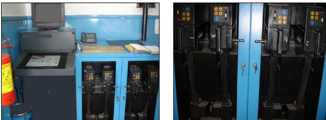
Εικόνα 32: Γενική άποψη του εξοπλισμού με τον οποίο γίνεται ηλεκτρονικά η ευθυγράμμιση (αριστερά) και μερική άποψη των 4 εξαρτημάτων που προσαρμίζονται στους τροχούς και με ακτίνες laser ευθυγραμμίζουν το όχημα (δεξιά).
