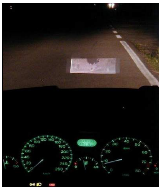
Εικόνα 45: Εικονική οθόνη συστήματος βελτίωσης ορατότητας.
