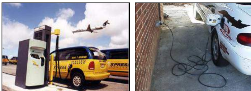
Εικόνα 23: Η φόρτιση δύο ηλεκτροκίνητων οχημάτων. Η αριστερή εικόνα δείχνει τον σταθμό φόρτισης οχημάτων εξυπηρέτησης κοινού σε ένα αεροδρόμιο της California, η δεύτερη δείχνει την φόρτιση ενός I.X. ηλεκτροκίνητου οχήματος στον προσωπικό χώρο στάθμευσης του οδηγού (Πηγές: AeroVironment, Jon Mauney).
