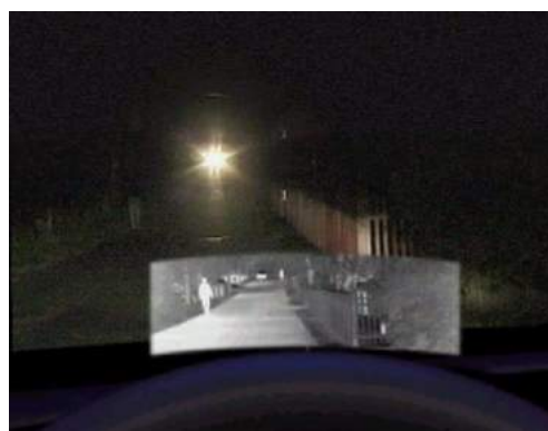
Εικόνα 46: Σύστημα βελτίωσης ορατότητας. Ας συγκρίνουμε πώς φαίνεται ο πεζός μέσω του συστήματος και πόσο δυσδιάκριτος είναι στην πραγματικότητα.
