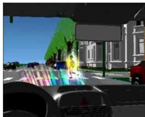
Εικόνα 44: Σύστημα εντοπισμού πεζών.
