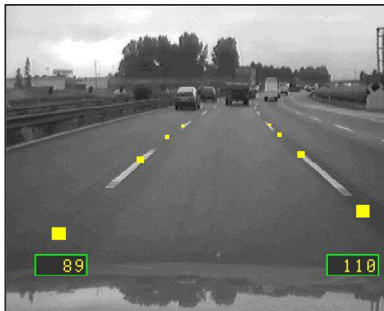
Εικόνα 47: Σύστημα ανίχνευσης λωρίδας.
