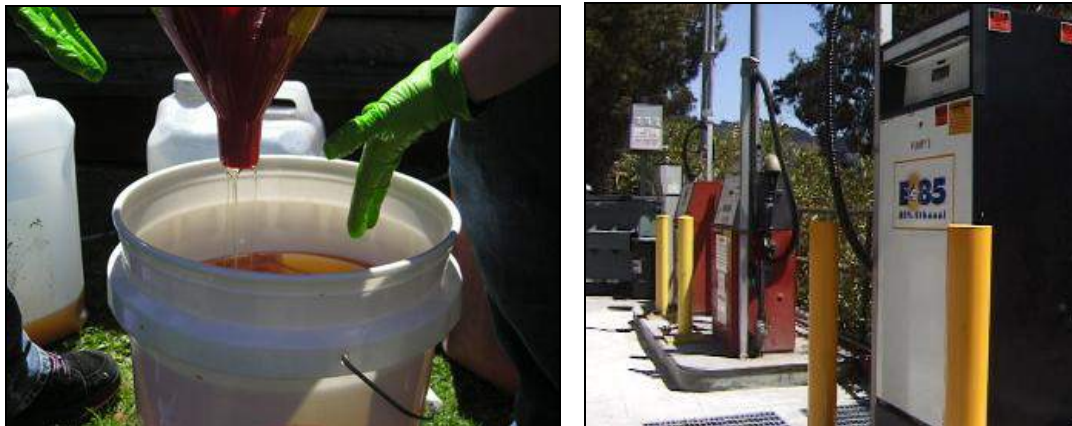
Εικόνα 29: Αριστερά η συλλογή χρησιμοποιημένου σπιτικού ελαίου στην Αυστρία. Κάθε σπιτικό δίνει σε μικρούς κουβάδες το λάδι που χρησιμοποιεί για μαγείρεμα, το οποίο με κατάλληλη επεξεργασία γίνεται βιοντίζελ για κίνηση οχημάτων. Δεξιά φαίνεται ένας σταθμός ανεφοδιασμού με την βενζίνη E85 που σημαίνει 85% αιθανόλη σε συμβατική βενζίνη (Πηγές: http://www.terram.cl/index.php?option=com_content&task=view&id=422 , http://cleanburnfuels.com/ ).
