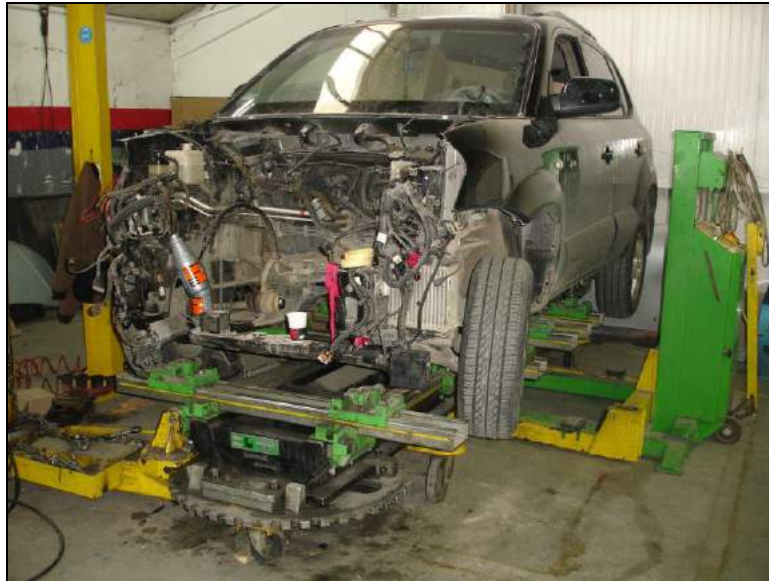
Εικόνα 29: Ειδικό μηχάνημα για την ευθυγράμμιση των αυτοκινήτων μετά από συγκρούσεις («καλίμπρα»).
