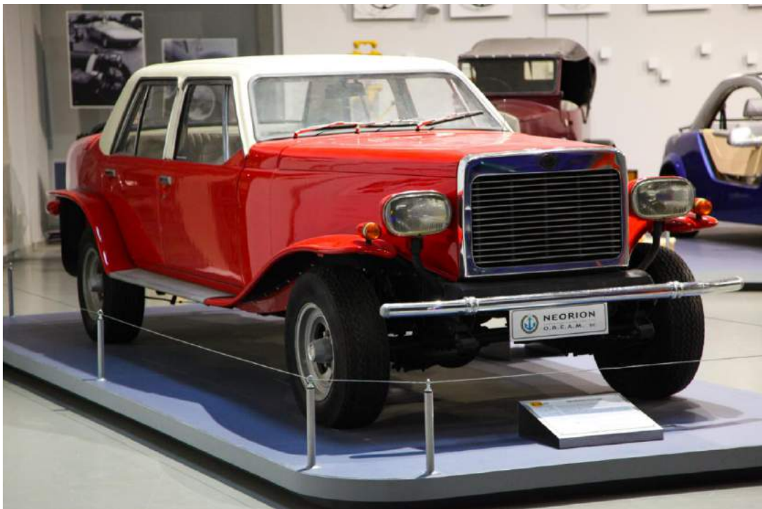
Εικόνα 3: «NEORION»-Το πρώτο ελληνικό αυτοκίνητο και το μοναδικό κομμάτι που διασώζεται από τα δύο που κατασκευάστηκαν το 1974. Πρόκειται για λιμουζίνα με κίνηση 4x4 και με την αισθητική αυτοκινήτου του 1930. Πέρα από τον κινητήρα και τα δύο διαφορικά, το υπόλοιπο είναι εξ ολοκλήρου ελληνικού σχεδιασμού και κατασκευάστηκε στο ναυπηγείο Νεωρίου στη Σύρο. (Πηγή: Έκθεση Αυτοκινήτων ΝΟΗΣΙΣ)
