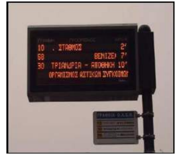
Εικόνα 1.19: Πινακίδα ένδειξης λεωφορειακών γραμμών που διέρχονται από στάση και χρόνου άφιξης σε αυτή
