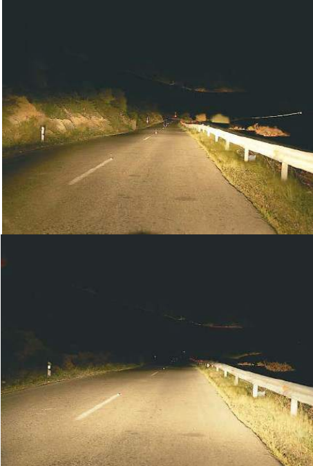
Εικόνα 2.48: Η διαφορά ανάμεσα στα φώτα πορείας (πάνω) και διασταύρωσης (κάτω)
