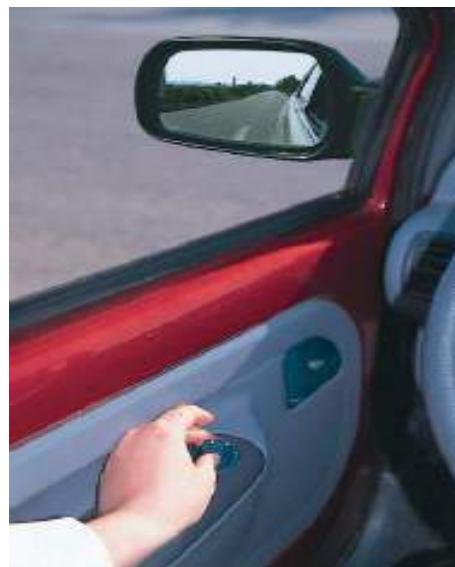
Εικόνα 2.42: Ρύθμιση αριστερού εξωτερικού καθρέπτη
