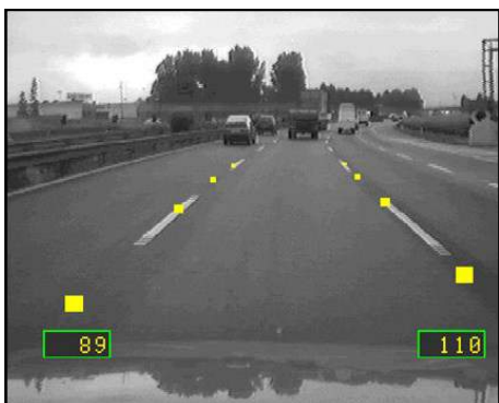
Εικόνα 5.38: Σύστημα ανίχνευσης λωρίδας.
