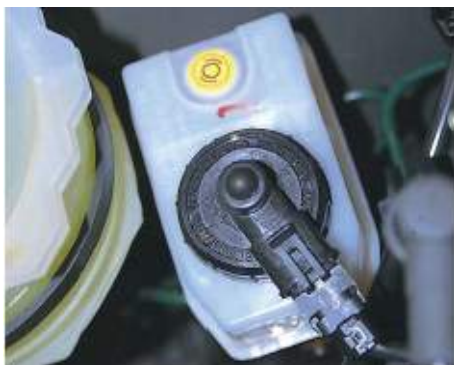
Εικόνα 5.10: Δεξαμενή υγρού φρένων
