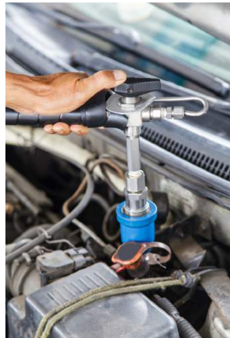
Εικόνα 6.7: Φόρτιση οχήματος φυσικού αερίου
