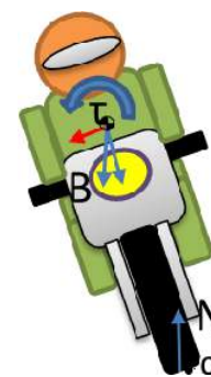
Εικόνα 2.62: Ανάλυση δυνάμεων όταν το δίκυκλο έχει μικρή κλίση
