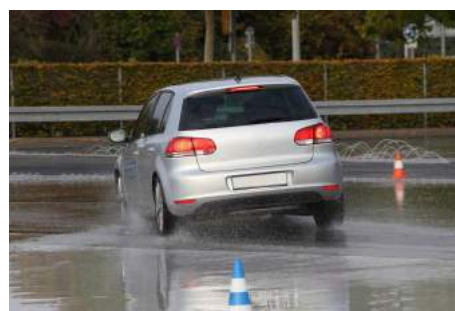
Εικόνα 2.19: Ανομοιόμορφη πέδηση σε υγρό οδόστρωμα
