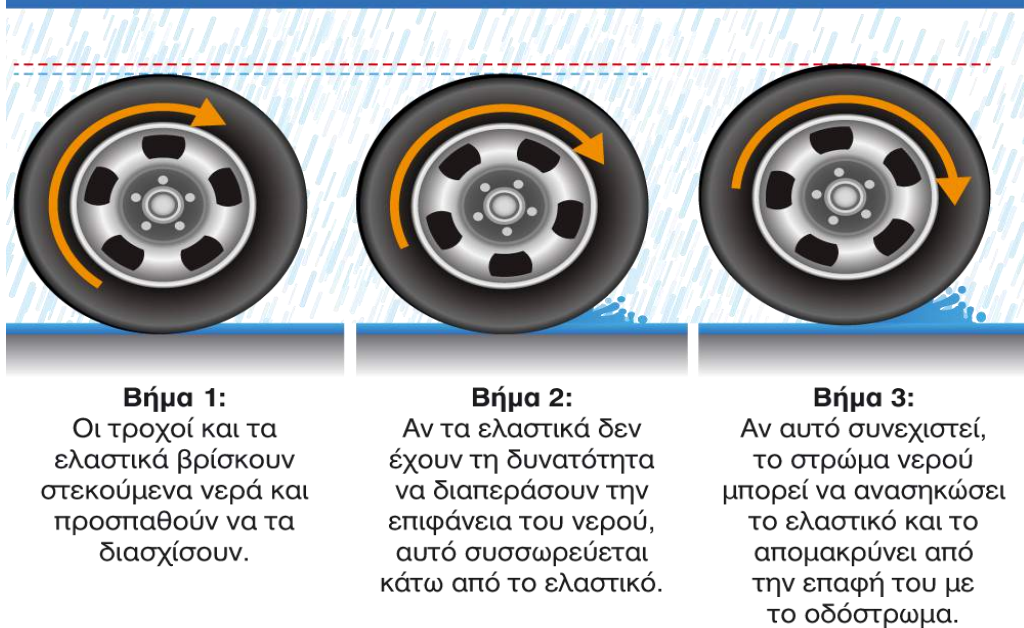
Εικόνα 2.33: Επεξήγηση του φαινομένου της υδρολίσθησης
