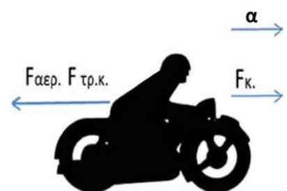
Εικόνα 2.56: Ισορροπία δυνάμεων σε ευθύγραμμη ομαλά επιταχυνόμενη κίνηση
