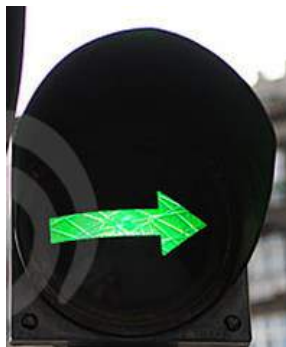
Εικόνα 4.23: Φωτεινοί σηματοδότες με μορφή βελών.
