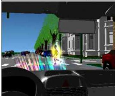
Εικόνα 5.35: Σύστημα εντοπισμού πεζών
