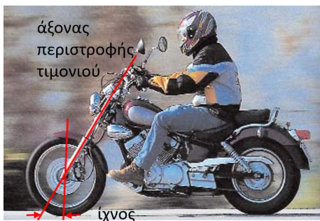
Εικόνα 2.68: Ορισμός του ίχνους του ποδηλάτου
