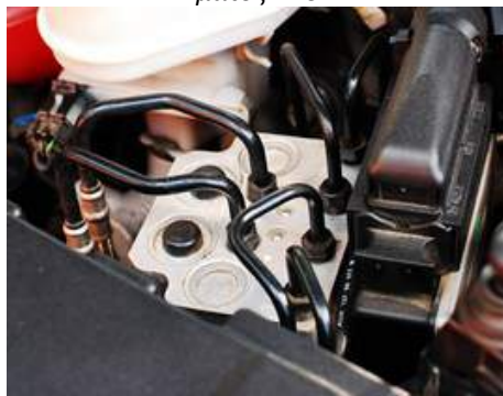
Εικόνα 5.24: Το σύστημα ABS
