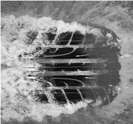
Εικόνα 2.31: Το ελαστικό όταν διέρχεται από συγκεντρωμένο νερό
