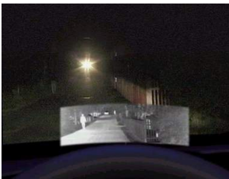
Εικόνα 5.36: Σύστημα βελτίωσης ορατότητας. Ας συγκρίνουμε πώς φαίνεται ο πεζός με τη βοήθεια του συστήματος και πόσο δυσδιάκριτος είναι στην πραγματικότητα.
