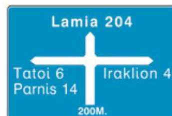
(Π - 1) Προειδοποιητική κατευθύνσεων η οποία τοπο- θετείται στις οδούς ταχείας κυκλοφορίας προ δια- σταυρώσεων με αναγράφες κατευθύνσεων και χιλιομετρικών αποστάσεων.
