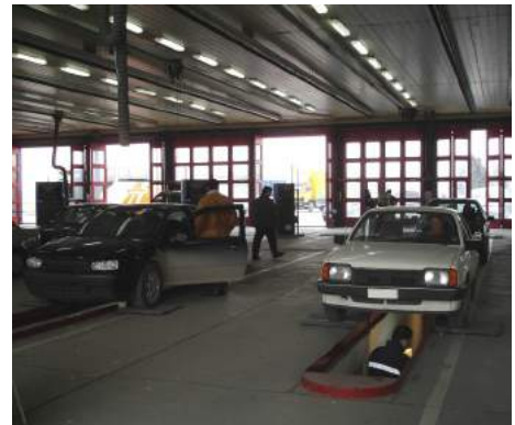
Εικόνα 1.14: Τα οχήματα εντός του ΚΤΕΟ εξετάζονται λεπτομερώς και από το κάτω τμήμα τους για τυχόν επικίνδυνες φθορές και βλάβες.
