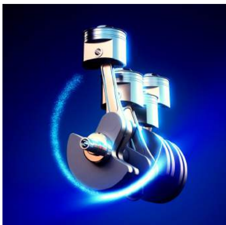
Εικόνα 5.7: Η μετατροπή της κίνησης του εμβόλου σε περιστροφική
