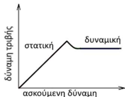
Εικόνα 2.73: Δύναμη τριβής σε συνάρτηση με την ασκούμενη δύναμη
