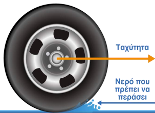
Εικόνα 2.31: Το ελαστικό όταν διέρχεται από συγκεντρωμένο νερό
