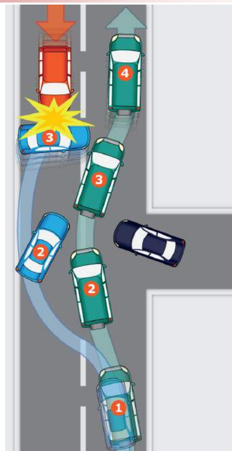
Εικόνα 5.28: Αποφυγή εμποδίου με απότομη πέδηση και προσπάθεια ελιγμού με και χωρίς ESP. ΠΡΟΣΟΧΗ: Στην περίπτωση που το όχημα δε διαθέτει ESP ή/και ABS, είναι φρονιμότερο κατά τον ελιγμό να αφήσετε εντελώς το φρένο.
