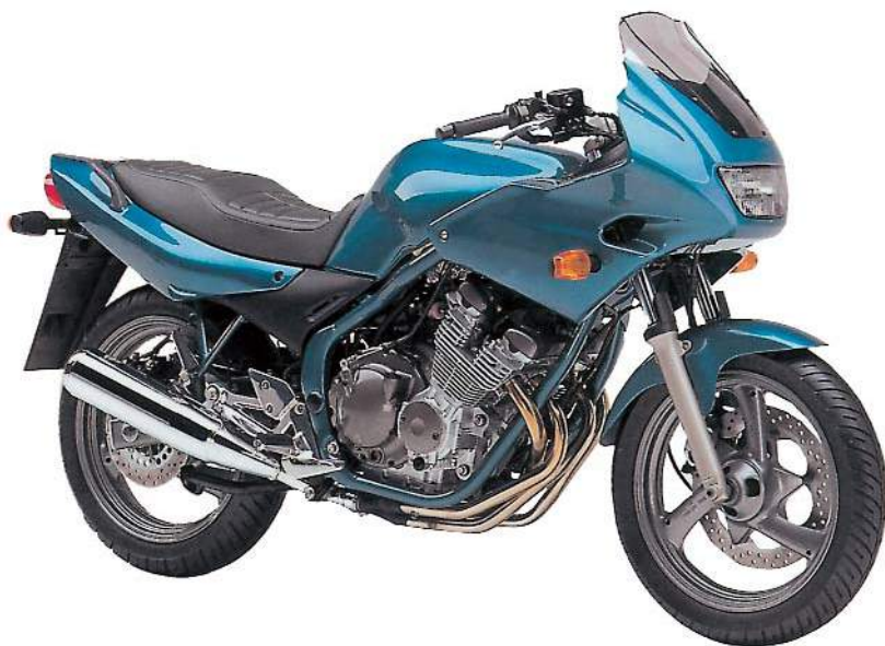
Σχ. 3.5γ Αεροδυναμική κατασκευή προστασίας τουριστικής μοτοσυκλέτας.
