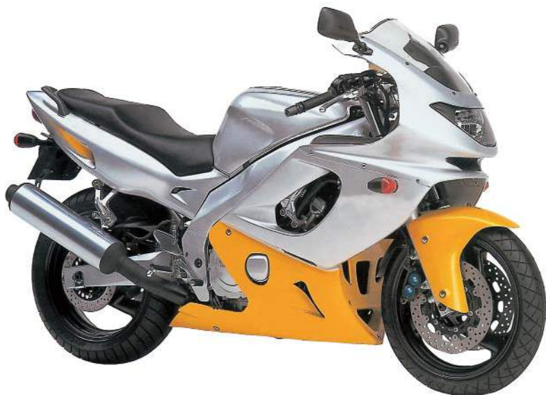
Σχ. 3.5β Ολόσωμη κατασκευή προστασίας.
