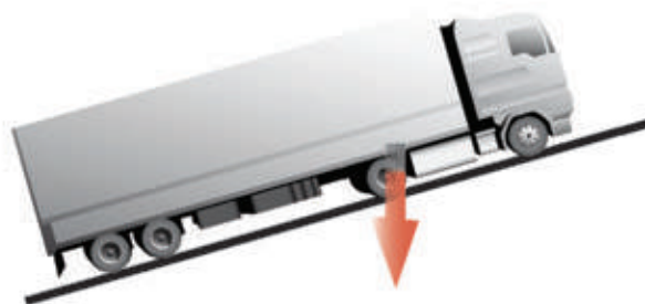
Σχήμα 2.26. Δύναμη βάρους σε ανωφέρεια
