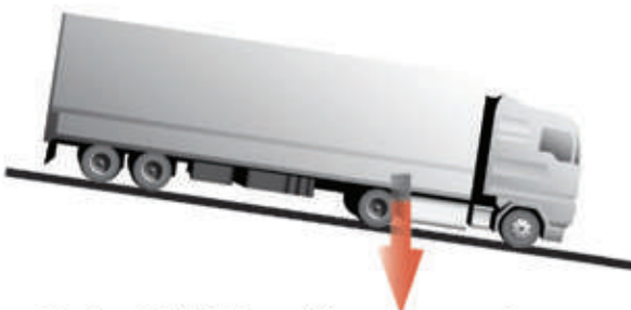
Σχήμα 2.27. Δύναμη βάρους σε κατωφέρεια
