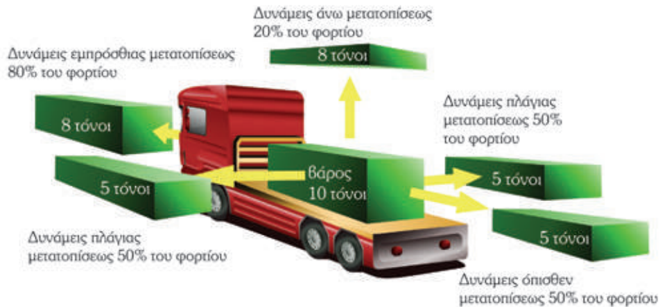
Σχήμα 2.29. Αναπτυσσόμενες δυνάμεις
