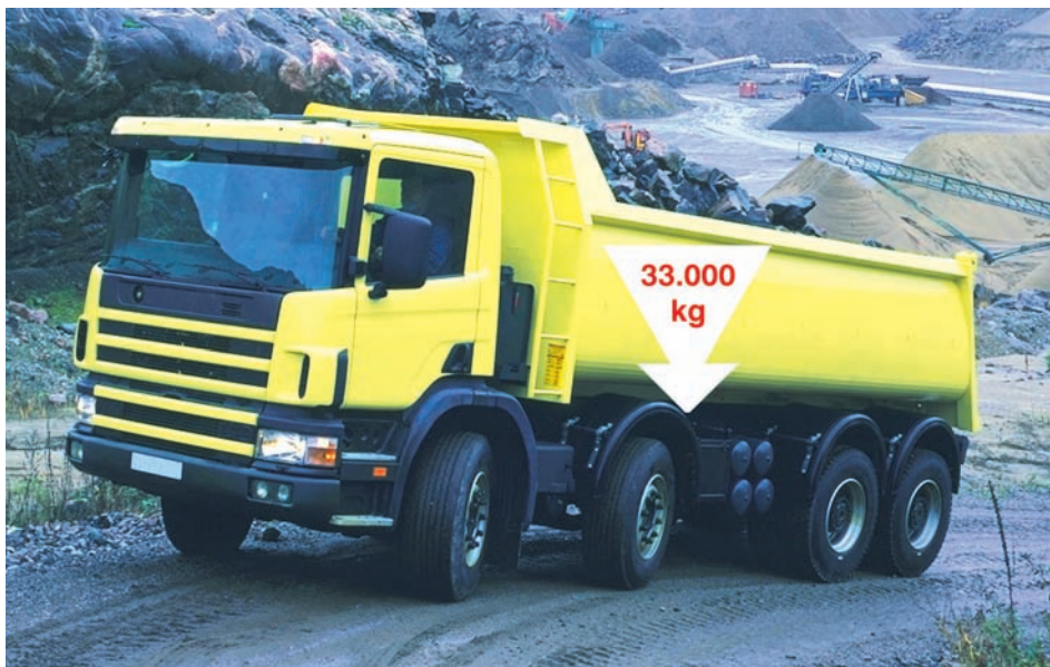
Σχ. 1.17 Μέγιστο επιτρεπόμενο βάρος τετραξονικού φορτηγού.
